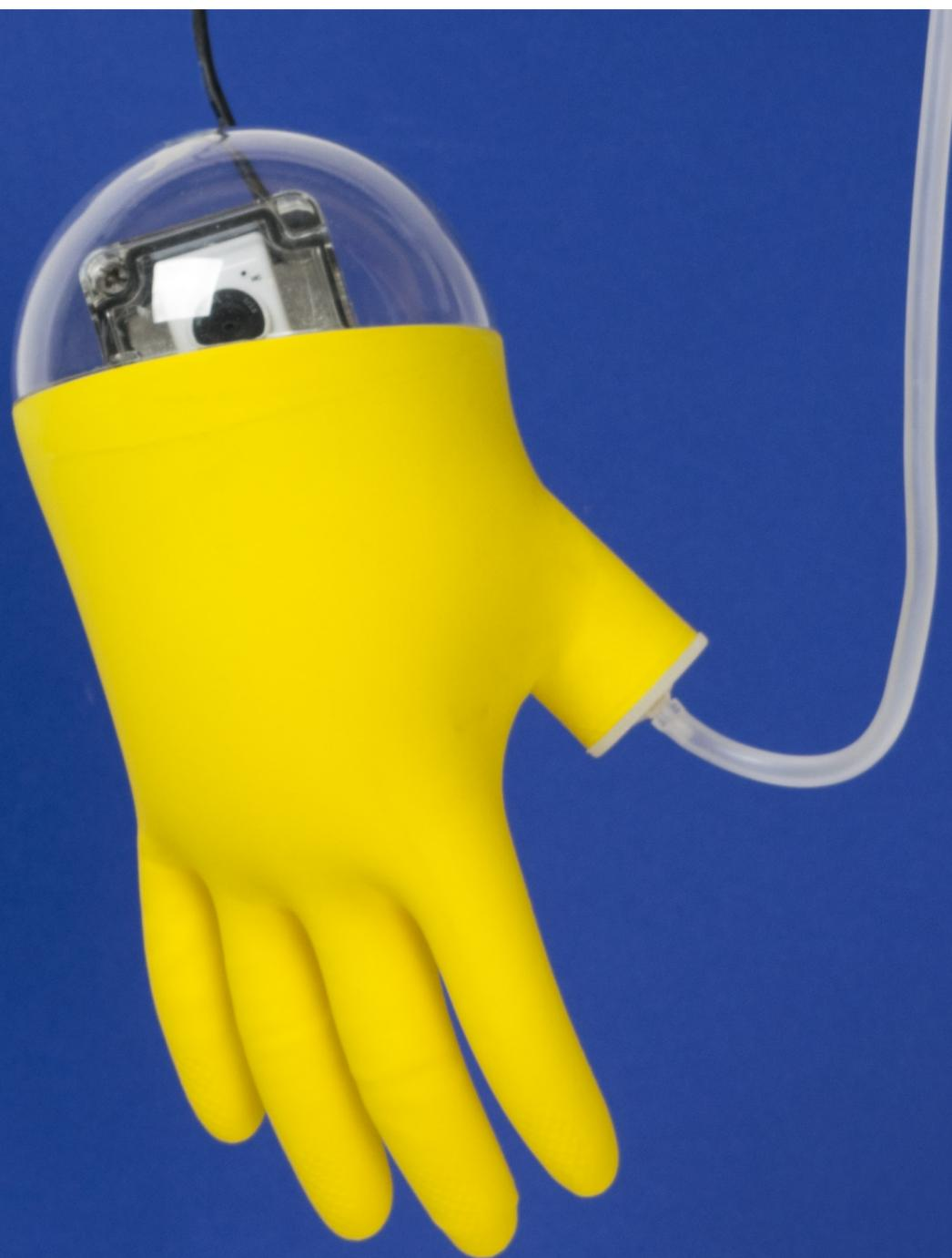
Ce prototype souhaite être un dispositif ludique d'animation dans les aquariums. Ce serait l'opportunité pour le visiteur de passer au delà de la vitre en contrôlant ce petit drone et d'accéder à ce monde sous marin particulier au travers de son regard. Dispositif technique simple, il est équipé d'une web-cam qui retransmet en direct l'image captée de son environnement.
