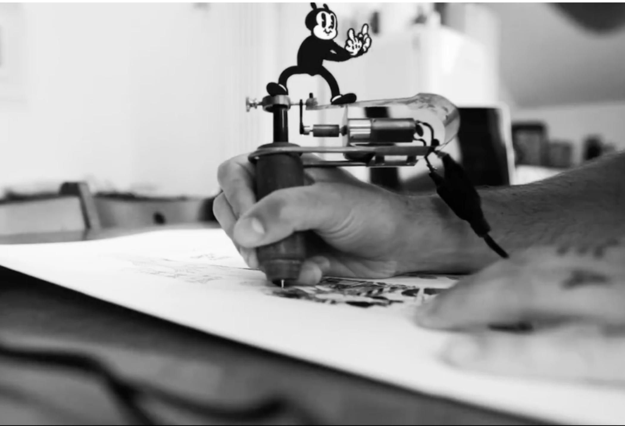
La Woody Dot Maker Machine a été spécialement conçue pour l'artiste illustrateur McBess. Objet unique inspiré des machines à tatouer, elle permet à l'artiste d'automatiser sa technique de shading faite d'un nuage de point. Cet outil entièrement conçu en atelier lui permet un gain de temps et évite une fatigue éprouvée à cause du geste répété des milliers de fois par le poignet.
